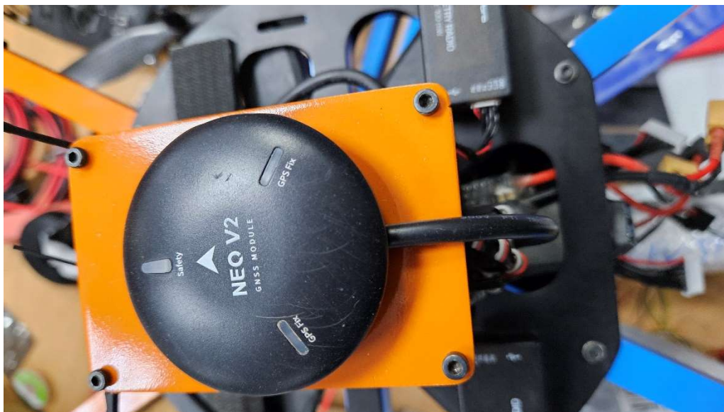
Рисунок 2.3 – Фотография Neo V2 GNSS, показывающая его монтажное расположение на БПЛА
